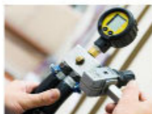
ガスシステム ガスシステムは圧力テストを行います。
