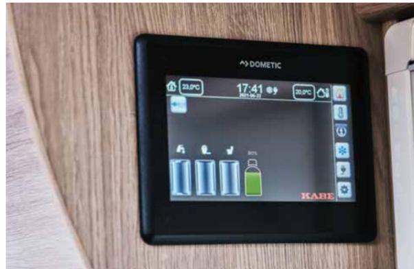
KABE Smart Level:2023年モデルから、3つのスマート機能を備えた新しいKABE Smart Levelを搭載したKABE Smart D panelとなりました。Smart Levelは、LPGレベル、タイヤ空気圧、停車中のキャンピングカーの傾きをモニターします。KABE Smart Levelであなたの快適なKABEライフがさらに充実!
