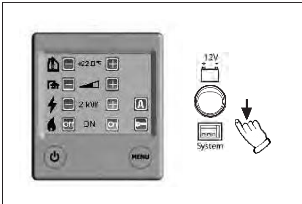
ボイラーのコントロールパネル
