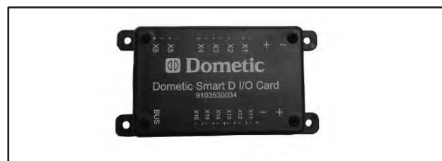
BUSシステムのN2～N6ユニットは次のとおりです。ドメティックSmart D I/Oカード
