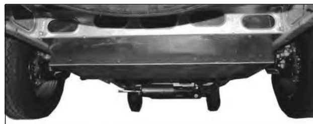
灰色の排水タンクは、キャンピングカーのリアアクスルの近くに取り付けられています
